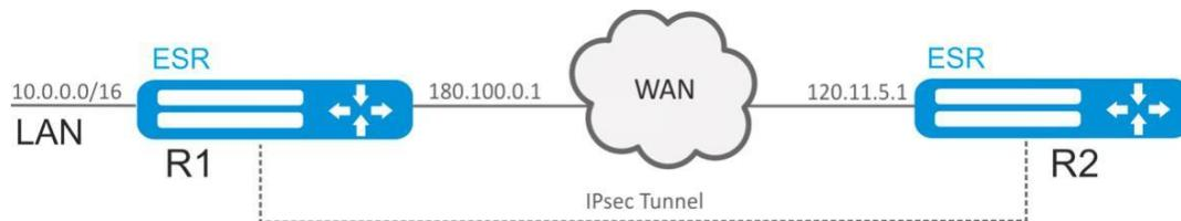
Настроить Remote Access IPsec VPN между R1 и R2 с использованием второго фактора аутентификации IPsec - XAUTH. В качестве сервера IPsec VPN настроить маршрутизатор R1, а маршрутизатор R2 в качестве клиента IPsec VPN.
