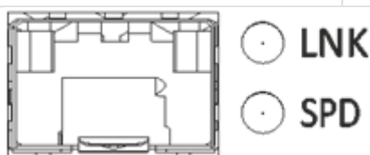
Рисунок 61 – Расположение индикаторов разъема SFP
