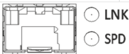
Рисунок 41 – Расположение индикаторов разъема SFP
