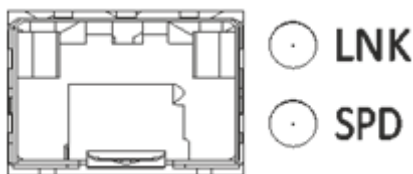
Рисунок 83 – Расположение индикаторов разъема SFP
