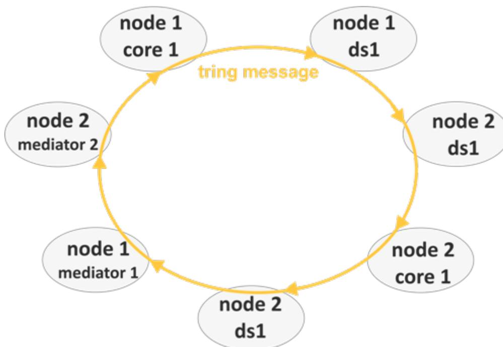
Рисунок 31 – Информационные потоки механизма мониторинга компонентов системы tring
