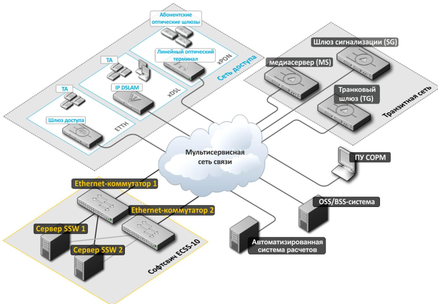
Рисунок 1 – Пример схемы включения комплекса ECSS-10
