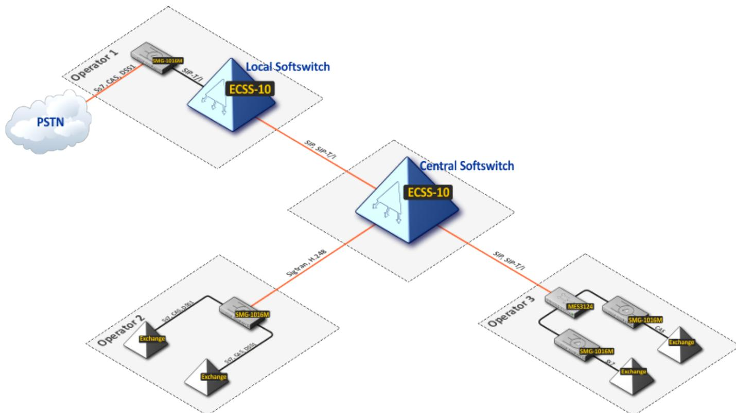
Рисунок 8 – Пример построения зонового узла связи на основе ECSS-10
