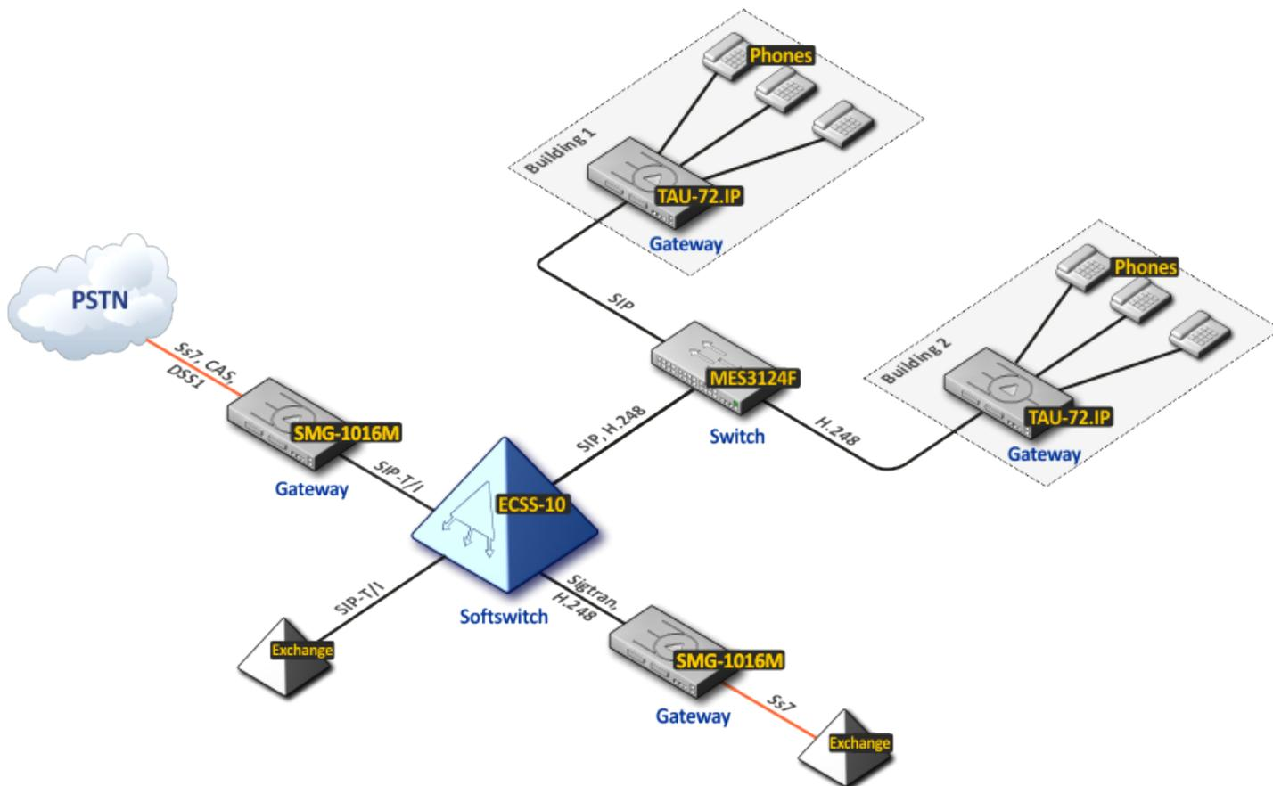
Рисунок 9 – Пример построения оконечно-транзитного узла связи на основе ECSS-10
