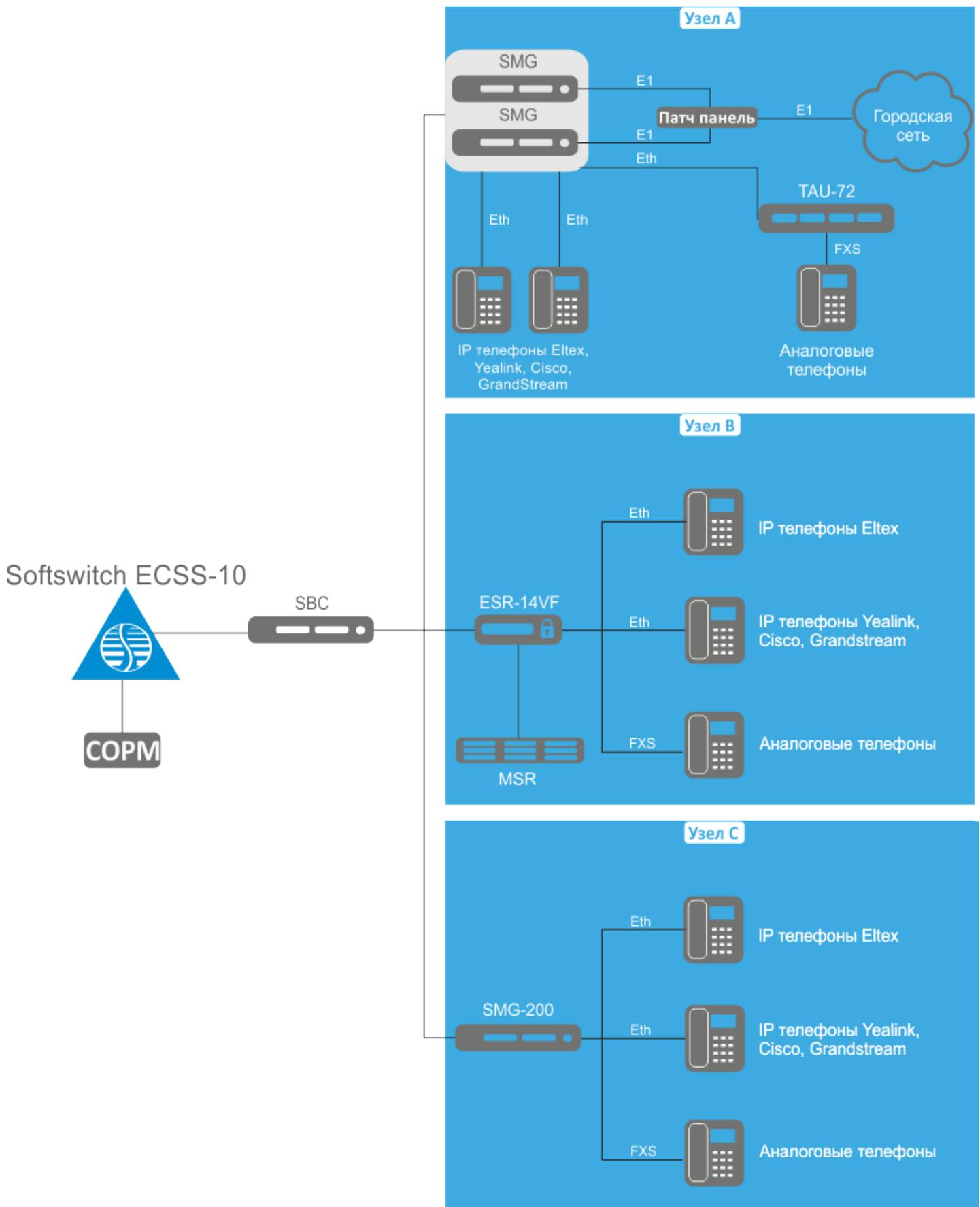
Рисунок 33 – Типовая схема организации распределенной отказоустойчивой сети
