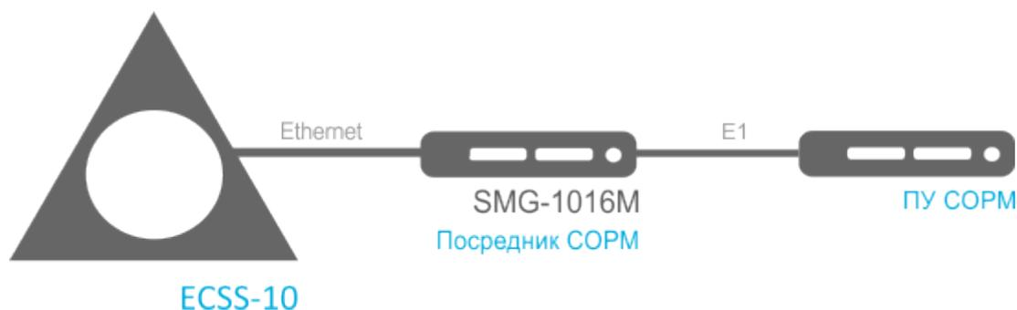
Рисунок 1 – Схема подключения ECSS-10 к ПУ СОПМ
