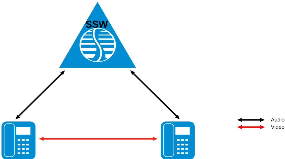
Рисунок 2 - Транзит видео включен
