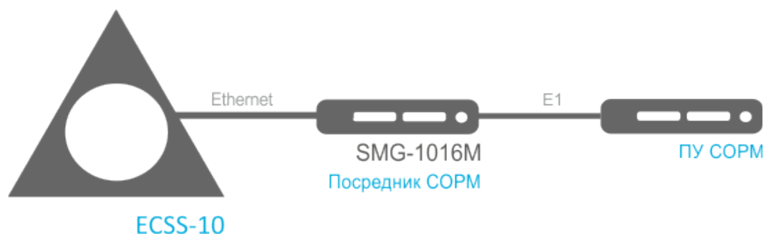
Рисунок 1 — Схема подключения ECSS-10 к ПУ СОПМ
