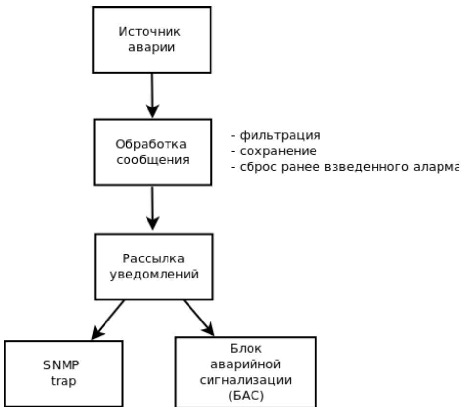
Рисунок 3 – Схема обработки предупреждений
