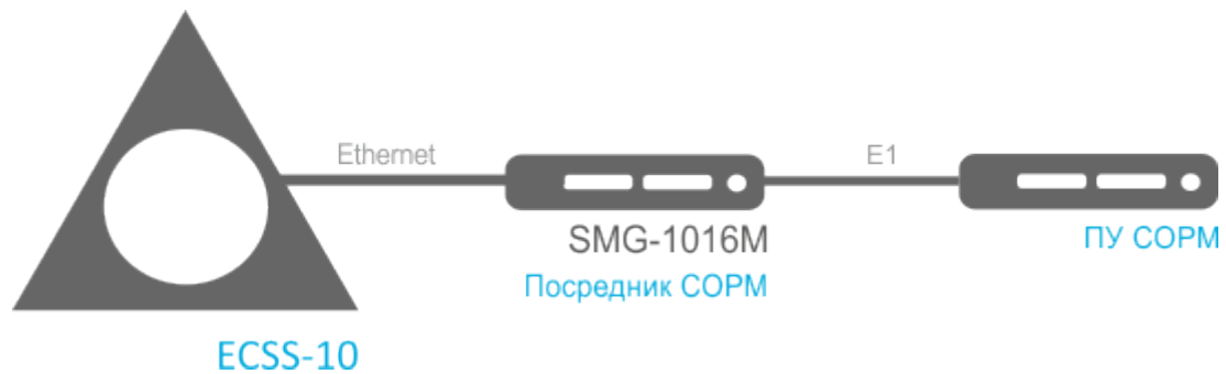
Рисунок 1 – Схема подключения ECSS-10 к ПУ COPM
